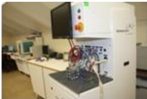
Станция тестирования топливных элементов (Hydrogenics)
